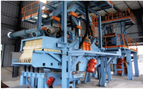
图6 浇冒口破碎清理系统示意图
