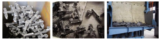
图5 回炉料破碎前后及清理后的图片
